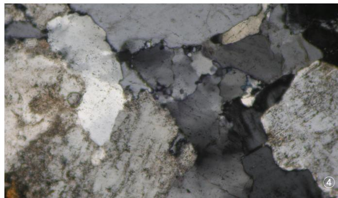
흑운모각섬석화강암은 중립질로서 반상 절리가 발달되어 있으며 무색광물이 우세한 우백질화강암이다. 주성분은 석영, 사장석, 정장석, 미사장석, 흑운모이고 부성분은 각섬석, 백운모, 견운모, 저콘, 철광석, 점토광물, 설석, 전기석 등이 있다. 석영은 2mm내외로 타형이며 부분적으로 파동소광을 하며 사장석은 2~3mm의 거정으로 알바이트(albite) 변정을 보이거나 변질되어 견운모 내지 점토광물로 오염된다. 0.1~0.3mm의 흑운모는 0.05mm의 저콘 소립자가 함유되어 혼륜(halo)을 형성하며 간혹 0.05mm의 미립결정이 취합되기도 한다. 각섬석은 0.1mm(±)의 자형결정으로 정내에 광물이 생성되고 있으며 약간의 다색성이 강한 전기석, 저콘, 백운모, 설석이 관찰된다.
